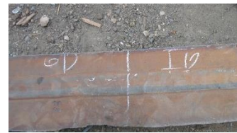
شکل ۶: نمونه آلوند پس از اره کاری اولیه و عملیات پرس
