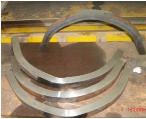
شکل ۱۵: نمونه تست خمش پس از آزمایش خمش در آزمایشگاه
