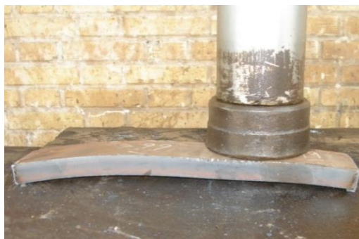
شکل ۲: عملیات پرس بر روی نمونه تست کشش ورق
