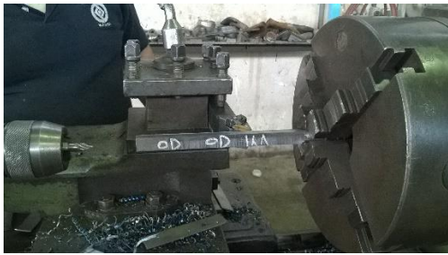
شکل ۸: نمونه آلوند حین تراش کاری
