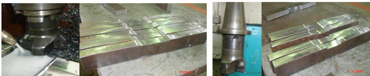
شکل ۴: فرز کاری مرحله دوم برای ایجاد انحنای نمونه تست کشش ورق
