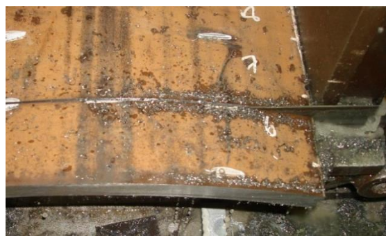
شکل ۱: نمونه بریده شده از لوله در حین اره کاری
