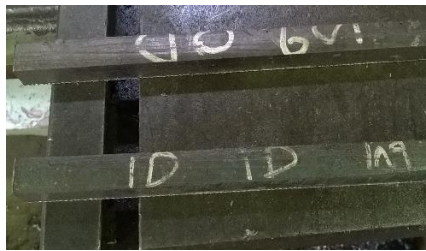
شکل ۷: ناحیه جوش بریده شده با اره نواری
