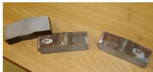
شکل ۱۱: نمونه سختی سنجی پس از اره کاری
