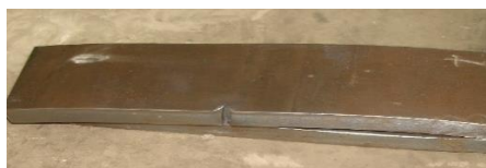
شکل ۲۰: نمونه تست دراپ پس از ناچ زنی
